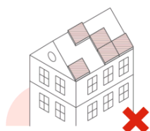
Šikmá střecha s panely různého, nesourodného umístění, velikosti nebo typu.
