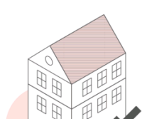
Šikmá střecha v plné ploše tvořená fotovoltaickým zařízením u zástavby se stávající krytinou netradiční skladby a barevnosti bez pohledového uplatnění z veřejného nebo poloveřejného prostoru.
